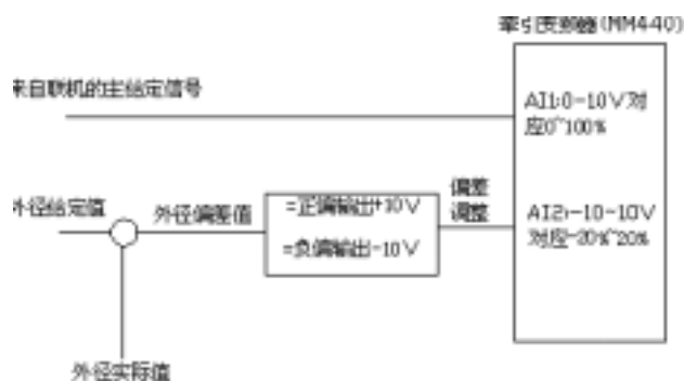
附图 3：外径自适应的调整原理
